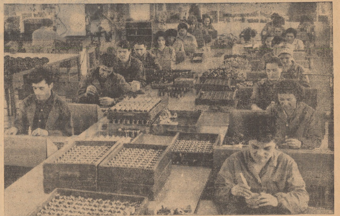
Banda de montaj vitezometre pentru autocamioane și tractoare a uzinei „Balanța” — Sibiu
