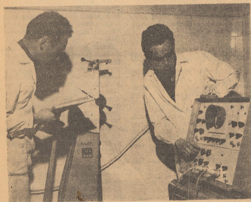
Aurel Maier și Dieter Theil din laboratorul de încercări fizico-mecanice al fabricii „Flamura roșie” din Sibiu, determinînd cu ajutorul ciocanului pendular, complete de înregistrări electronice cu ajutorul oscilografului, rezistența materialelor la soc, folosite în secția metal și termoplastice
