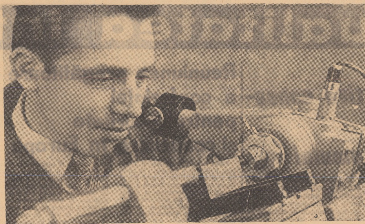
La laboratorul metrologic al uzinei „Independența” din Sibiu, cu ajutorul aparatului universal de verificat lungimi de ordinul micronilor, metrologul Liviu Dragomir controlează trusele de micrometre pentru măsurarea interioarelor
