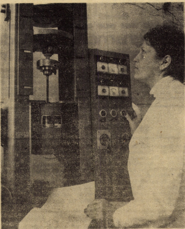
Determinarea viscozității pastei, folosită la articole de scris, cu ajutorul rheoviscozimetruului în laboratorul chimic al întreprinderii „Flamura roșie” Sibiu Foto: Fred NUSS
