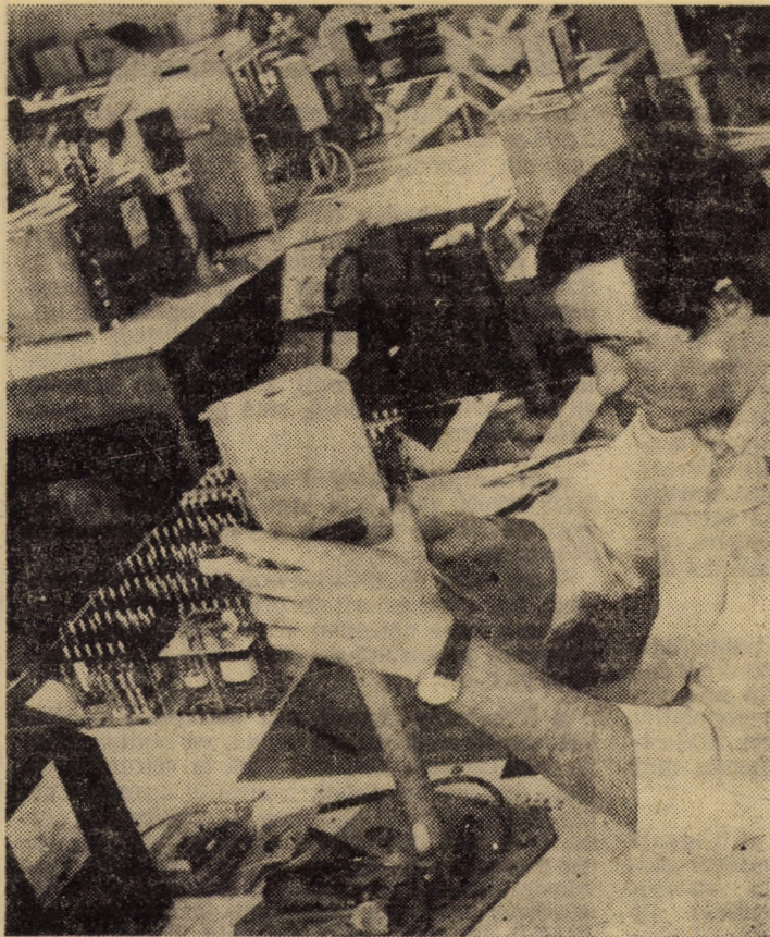
Controlul electric al releelor de temporizare la capătul liniei de montaj — fază de lucru de care depinde funcționarea în exploatare a produselor întreprinderii de relee Mediaș. Foto: Fred NUSS
