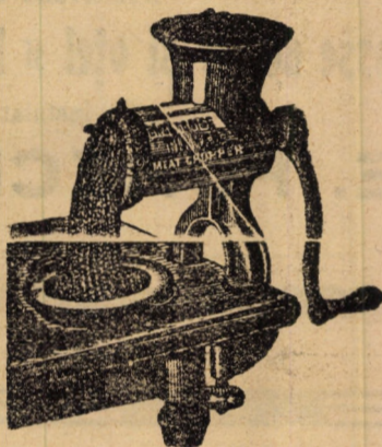
Partile constitutive dela mașina de tocat carne. a) Inel de capac, b) Disc găurit, c) Cuțit, d) Ș rof dela întorcător, e) Întorcător, f) Melciul, g) Tăp. — Fiecare să capătă separat. —
