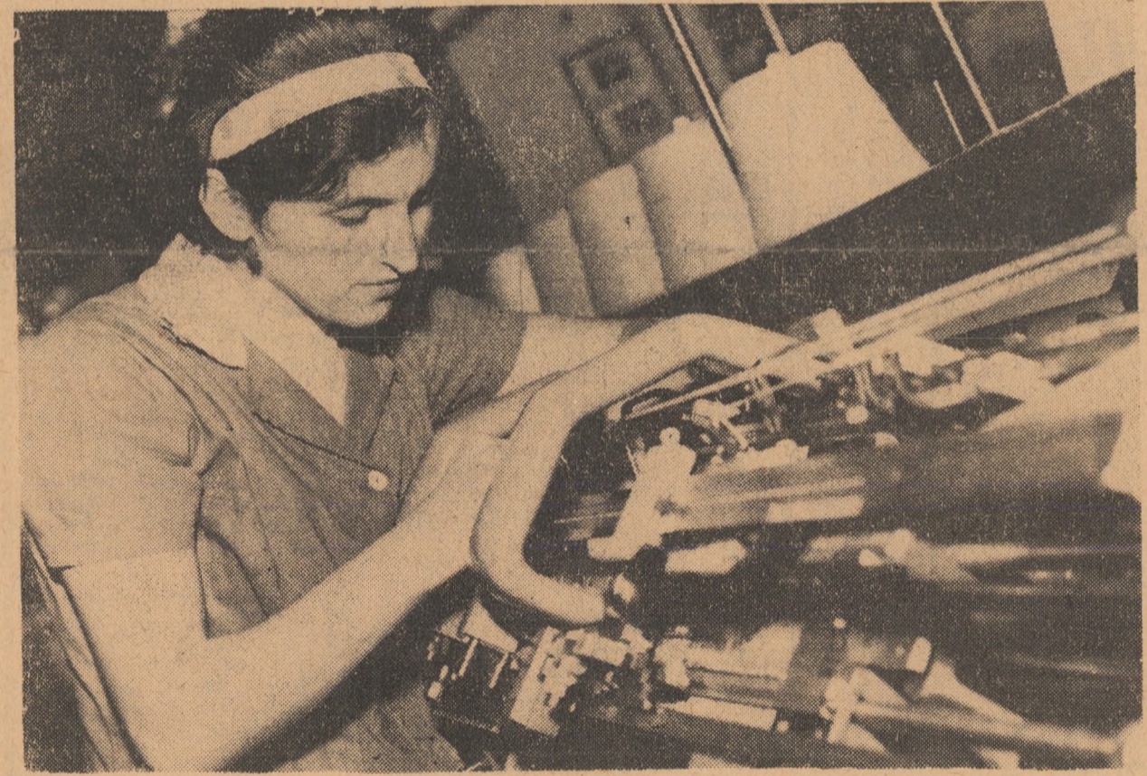
Fabrica „Drapelul roșu” Sibiu. La o mașină automată de tricrat recelînă, cu două sisteme și comandă automată pe bază de cartela, Minodora Ungureanu, muncitoare cu o bună pregătire profesională, realizează în 8 ore subsansamble pentru 16 pulovere.
