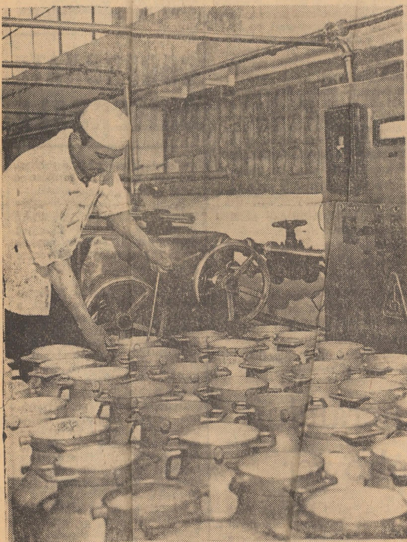
În secția pasteurizării smîntînirii laptelui de la I.C.I.L. „Sibiana” din Mediaș, cu ajutorul instalațiilor existente, sînt prelucrate 50 000 litri lapte în 24 ore
