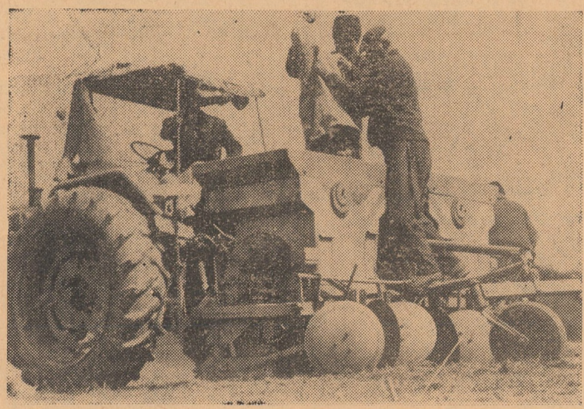
Cooperatorii din Birghiș lucrează cu toate forțele la plantatul cartofilor. Mecanizatorul Nicolae Roman, împreună cu membrii cooperatori care deservesc această mașină de plantat cartofi acoperă zilnic, în tarlăua „La Raț”, o suprafață de 4,5—5 ha.
